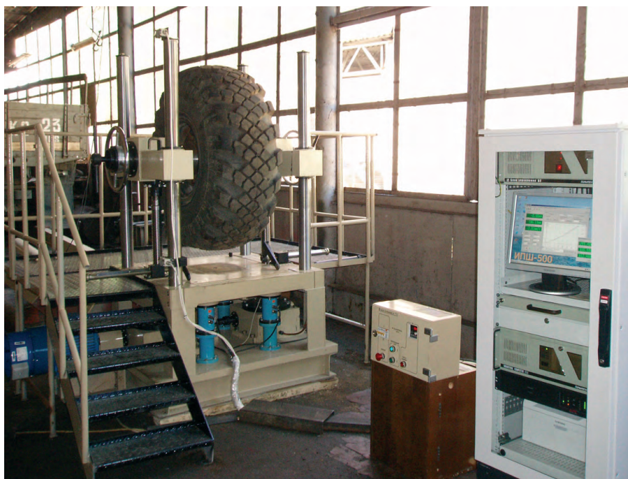
Рис. 1. Внешний вид стенда ИПШ-500
