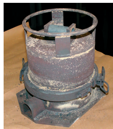
Рис. 2. ЗН-МС-1 после высокотемпературного пожара
