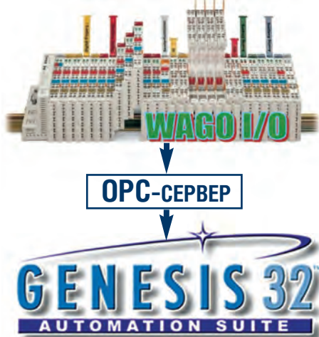
Рис. 1. Система состоит из каплера WAGO I/0 750-342, OPC-сервера и SCADA GENESIS32
