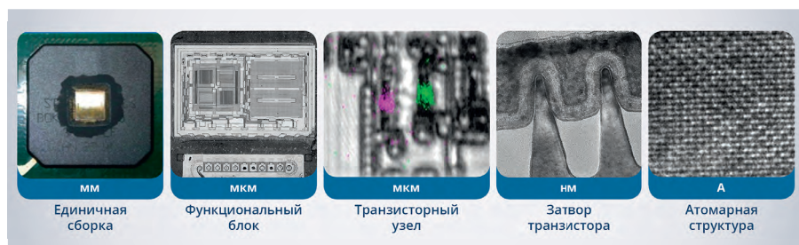
Рис. 1. Геометрическая градация отказов по размерности
