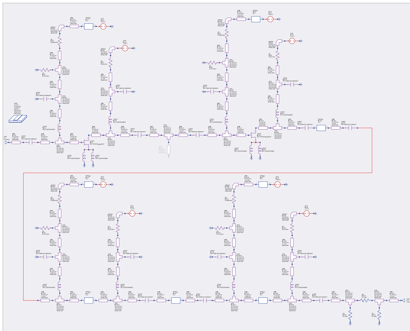
Рис. 2. Схема МШУ в модуле Circuit Schematics
