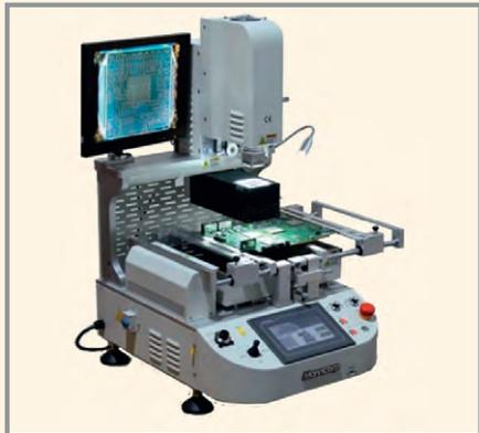
Новая система предназначена для решения самых сложных задач, связанных с ремонтом современных печатных плат. Универсальность RW1210 обеспечивается благодаря наличию следующих функций:
