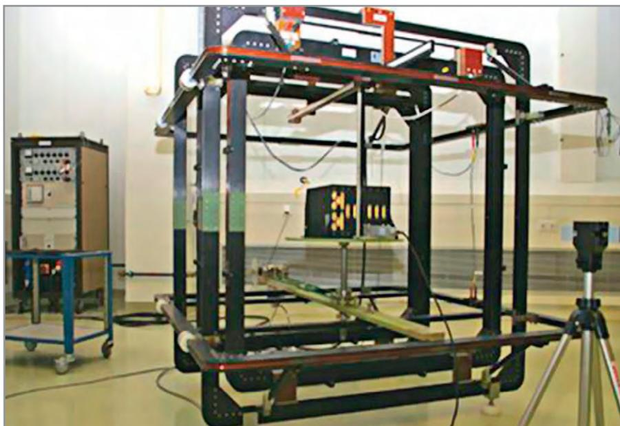
Рис. 6. Стенд для проверки на устойчивость к электромагнитным полям
