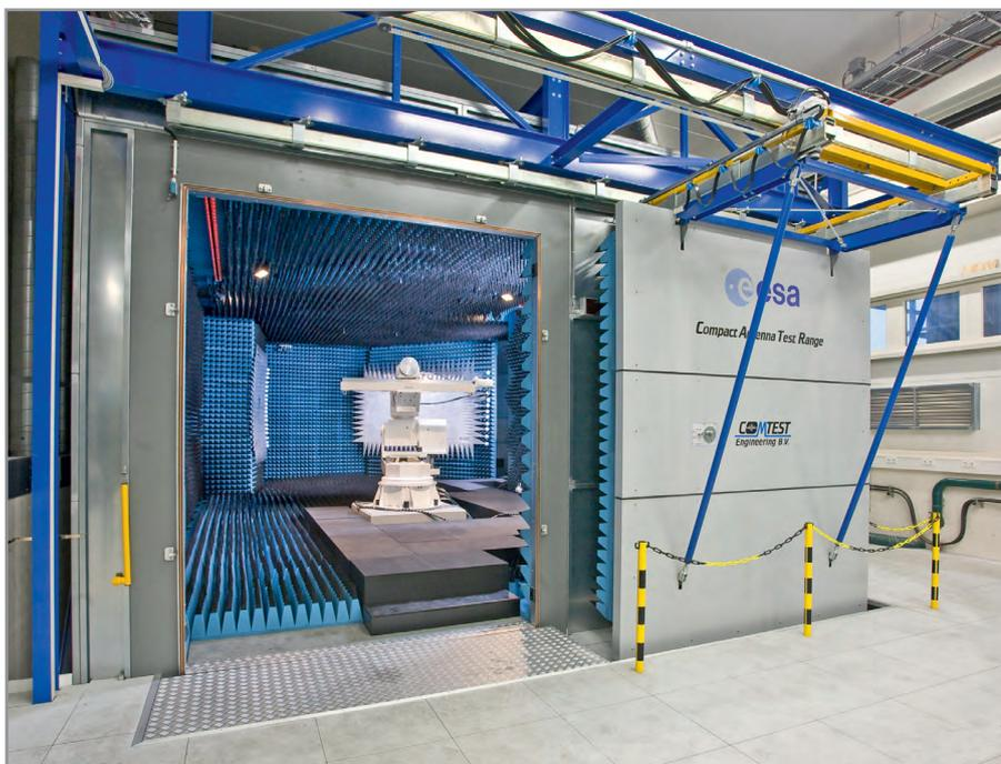
Рис. 1. Компактный антенный полигон Электромагнитной лаборатории
