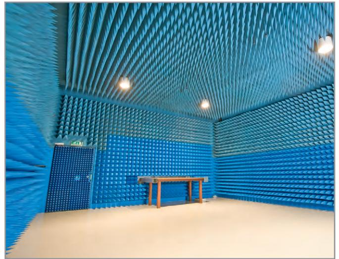
Рис. 3. Покрытие радиопоглощающим материалом безэховой экранированной камеры для испытаний на ЭМС
