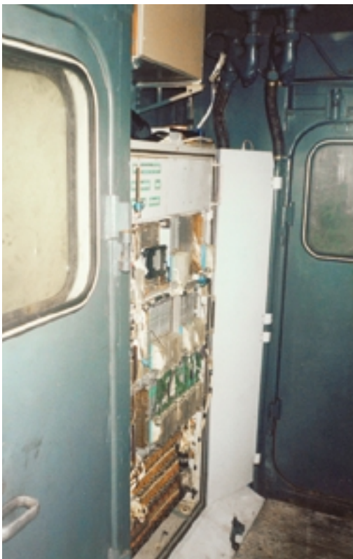
ЦБУ АПК «Пилот» в процессе эксплуатационных испытаний
