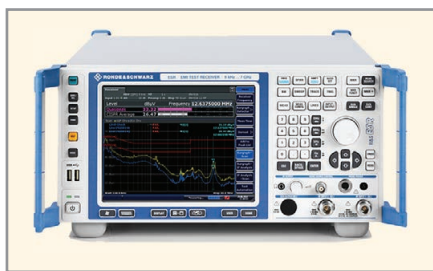
Рис. 2. Внешний вид измерительного приёмника Rohde&Schwarz ESR 26
