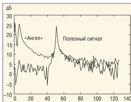
Рис. 3. Спектры сигналов на входе и выходе предложенной системы СДЦ
