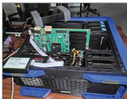
Рис. 5. Плата, вставленная во внутренний разъём PCIe
