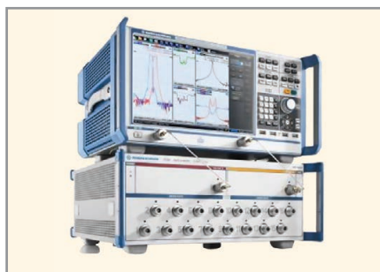
Рис. 3. Измерительный комплекс Rohde&Schwarz на основе расширителя портов ZV-Z81
