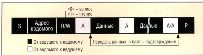
Рис. 18. Формат обмена данными по шине I 2 C для режима ведущего передатчика
