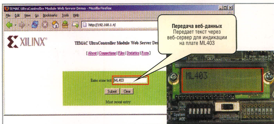
Рис. 2. Пример веб-сервера, обеспечивающего удалённое управление платой ML403
