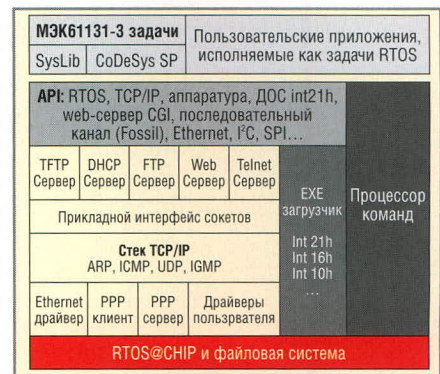
Рис. 2. Архитектура RTOS IPC@CHIP, реализованная в SC13-IEC
