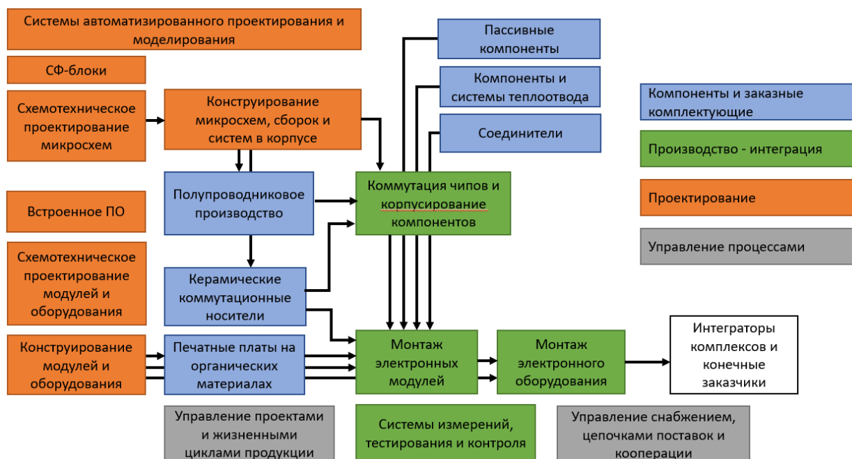
Рисунок 3. Основные технологические переделы электронной промышленности
