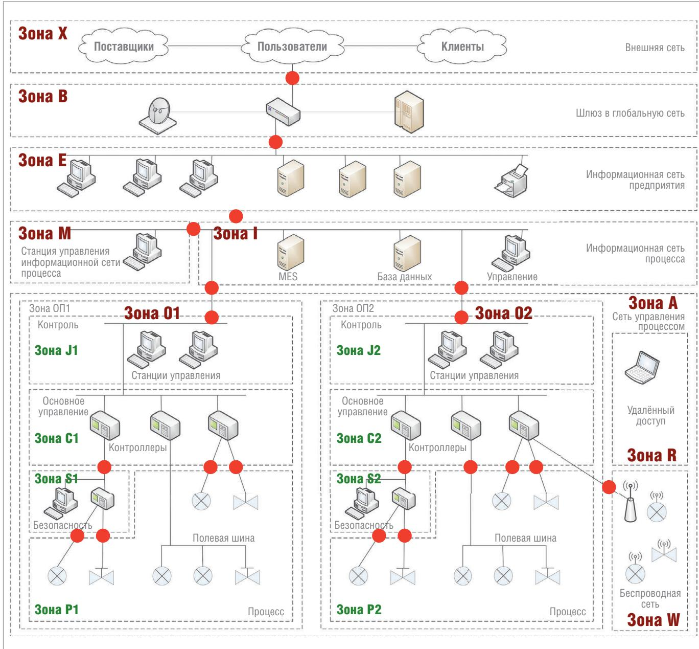
Рис. 4. Схема зон и путей нефтеперегонного завода
