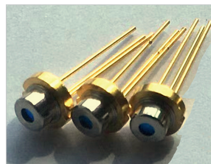
Рис. 10. Современный одномодовый диодный VCSEL-лазер с вертикальным излучением на основе GaAsP/AlGaAs
