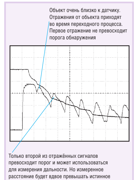
Рис. 5. Эффект многократных отражений при нахождении объекта в «слепой» зоне
