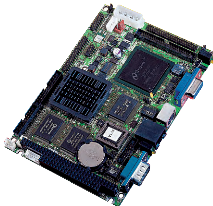
Рис. 6. Внешний вид одноплатного компьютера PCM-5825 Advantech
