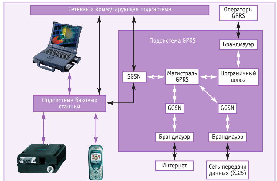
Рис. 1. Структура системы GPRS
