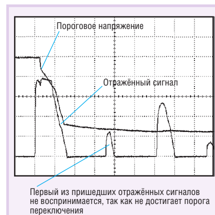
Рис. 8. Подавление отражённых сигналов от возмущающих объектов с помощью регулируемого порога переключения
