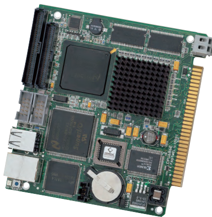
Рис. 4. Одноплатный компьютер в формате MicroPC с интерфейсом Ethernet фирмы Fastwel
