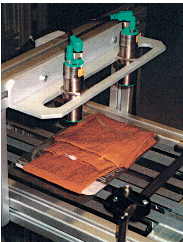
Рис. 18. Определение ориентации пакетов на упаковочной линии
