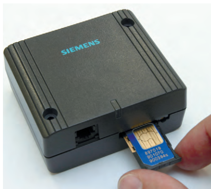
Рис. 2. Внешний вид модема MC35 Terminal
