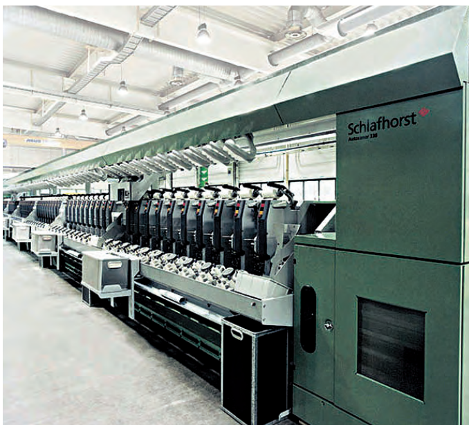
Рис. 15. Общий вид намоточного станка Autoconer 338
