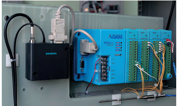
Рис. 4. Подключение модема MC35 Terminal к контроллеру ADAM-5000
