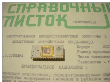
Рис. 1. Первый отечественный программируемый сигнальный процессор КМ1813ВЕ1 на фоне справочного листа с его описанием
