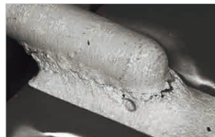
Рис. 4. Внешний вид паяного соединения центрального проводника соединителя с полском печатной платы
