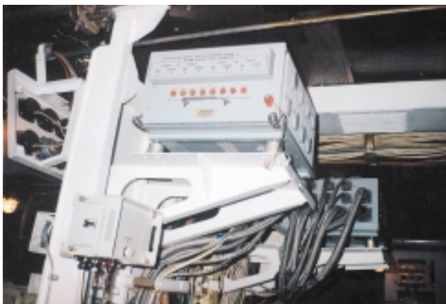
Рис. 5. Машинное отделение. Блок дистанционного автоматизированного управления
