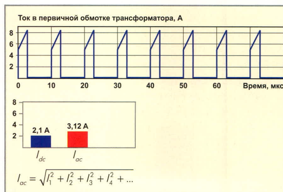
Рис. 7. Форма и компоненты тока в обмотке трансформатора
