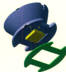
Рис. 13. Принцип крепления линзы на плату
