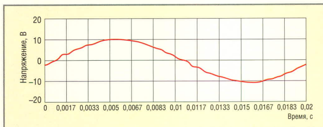
Рис. 10. Напряжение на нагрузке ( L = 6 мГн, C = 0,6 мкФ)
