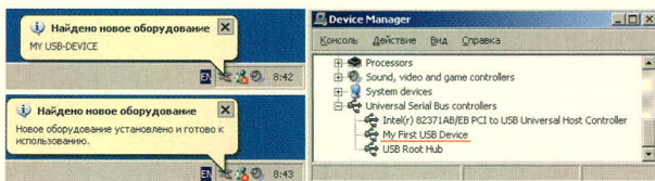
Рис. 14. USB-устройство в среде ОС Windows
