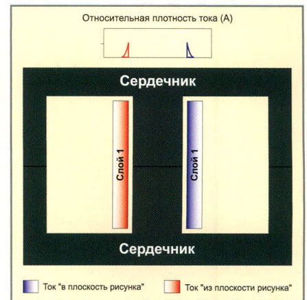
Рис. 2. Распределение тока в однослойной обмотке дросселя
