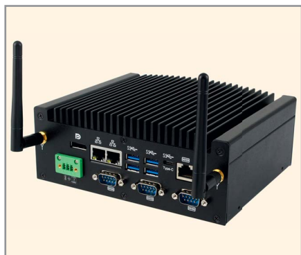
Рис. 3. Безвентиляторный встраиваемый компьютер iBASE ASB200-915 на базе платы IB915 с процессором Skylake
