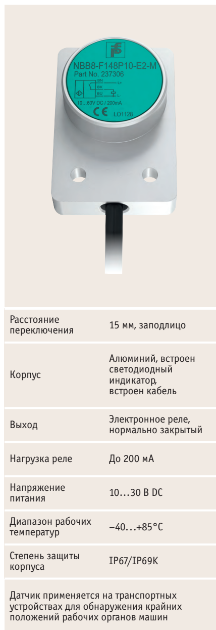
Рис. 15. Индуктивный датчик NBB15-F148P10-AR0-M для применения на транспорте и в жёстких условиях эксплуатации
