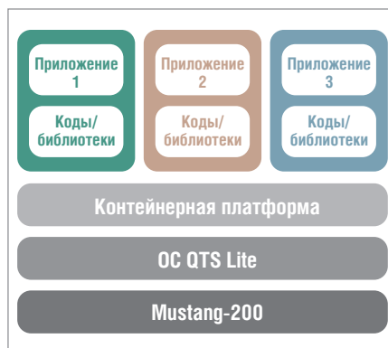
Рис. 4. Запуск контейнерных приложений на акселераторе Mustang-200
