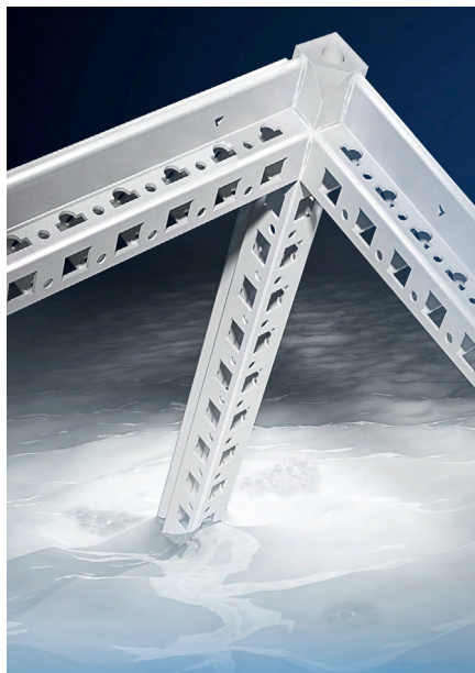
Рис. 4. Электрофорезное грунтование каркаса шкафа
