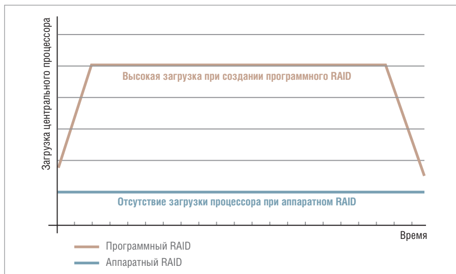
Рис. 2. График загрузки центрального процессора для аппаратного и программного RAID
