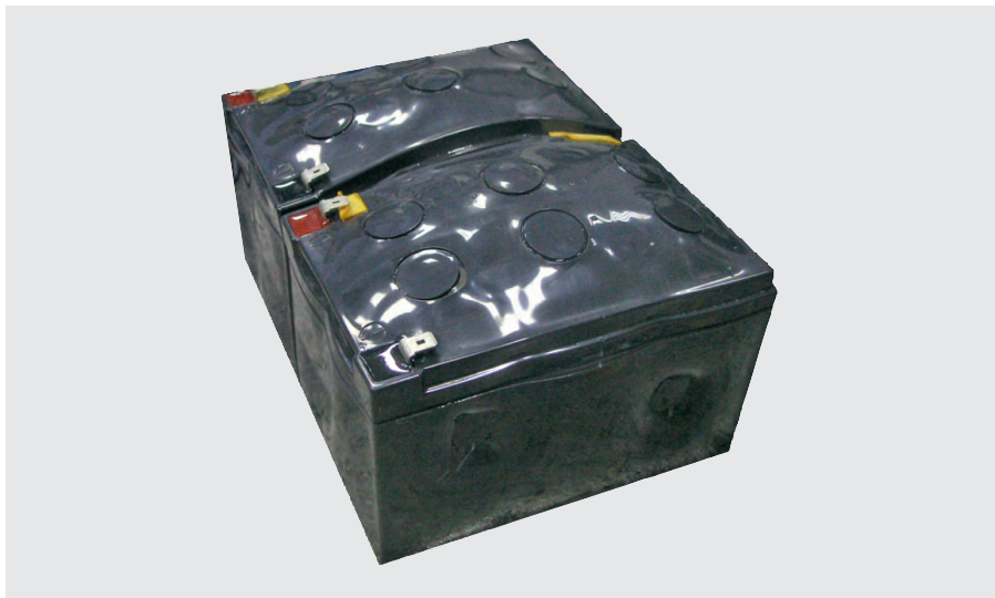
Рис. 2. Изменение геометрии корпуса в результате термического разгона
