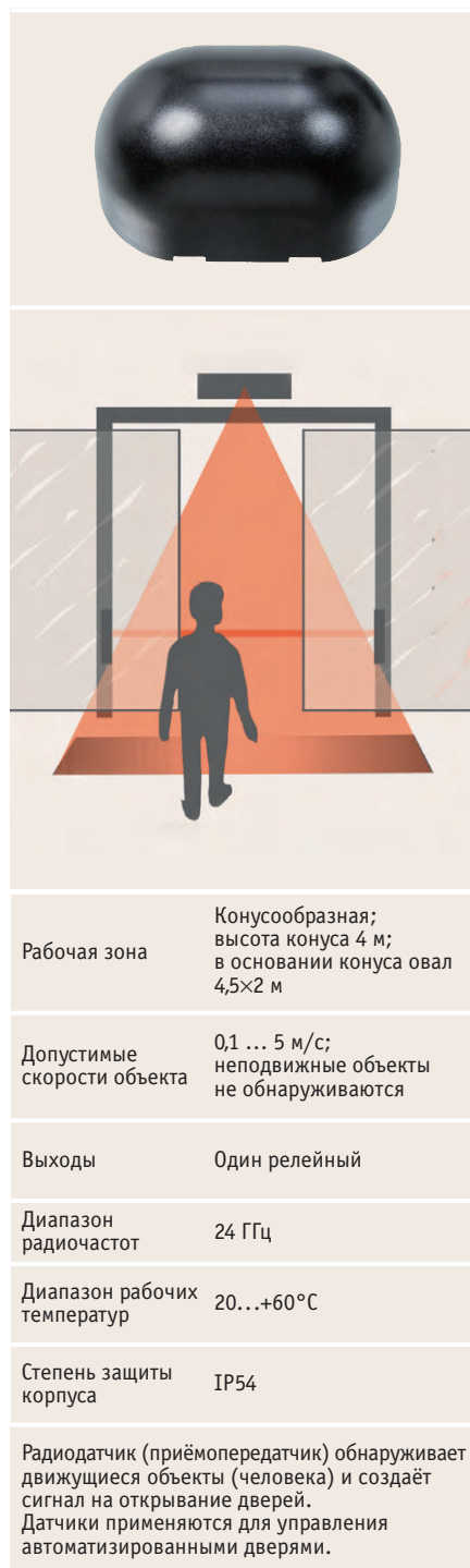
Рис. 31. Радиодатчик RaDec-M обнаруживает движущиеся объекты в рабочей зоне датчика
