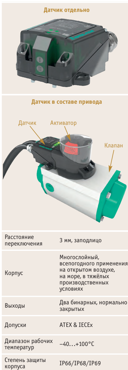
Рис. 14. Сдвоенный индуктивный датчик NCN3-F31K2M-N4-B13-S в исполнении Namur в управляемом электроклапане определяет положение клапана «открыт/закрыт»
