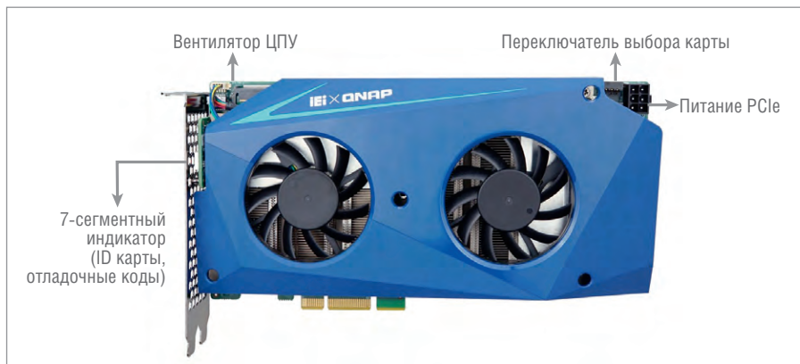
Рис. 6. Расположение коннекторов Mustang-200 с лицевой стороны
