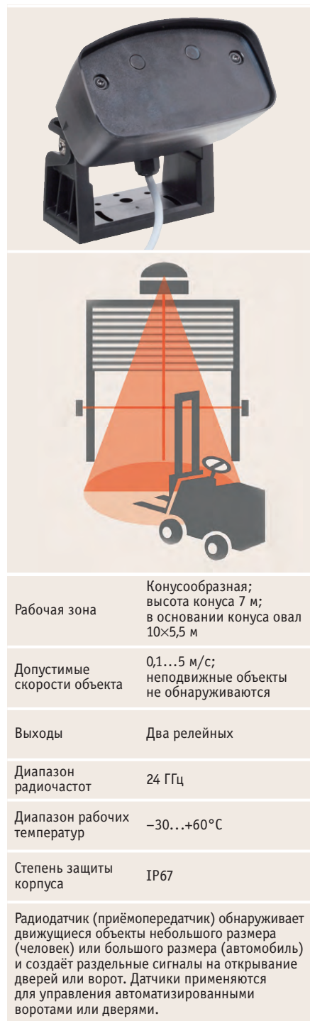
Рис. 30. Радиодатчик RAVE-D обнаруживает движущиеся объекты в рабочей зоне датчика
