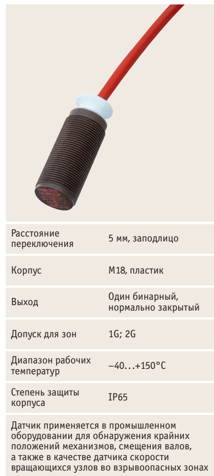
Рис. 13. Индуктивный датчик NJ5-18GK-N-150 во взрывозащищённом исполнении Namur
