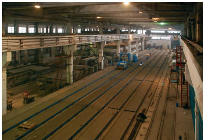
Линия по производству плит перекрытия
