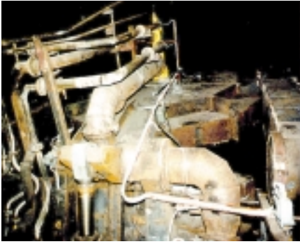
Рис. 2. Стенд сушки и разогрева сталеразливочных ковшей
