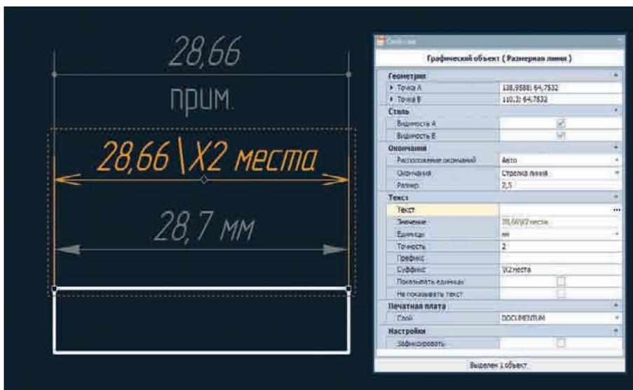
Рис. 20. Три варианта представления горизонтальной размерной линии
