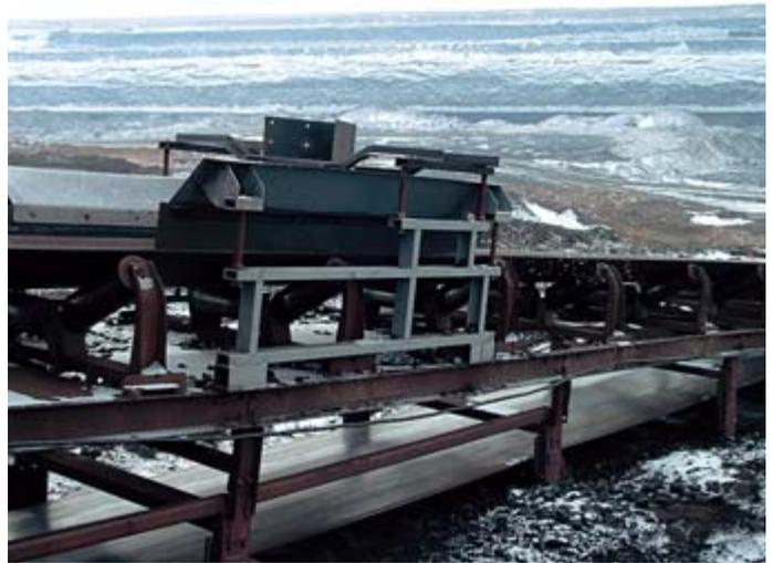
Рис. 8. Формирователь потока угля на конвейерной ленте, установленный перед датчиком зольности ГДЗ-7683
