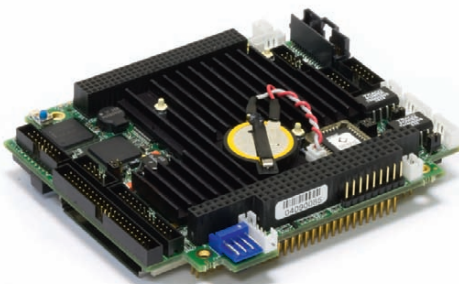
Рис. 1. Процессорная плата FASTWEL CPC304 с диапазоном рабочих температур от -50 до +85°C
