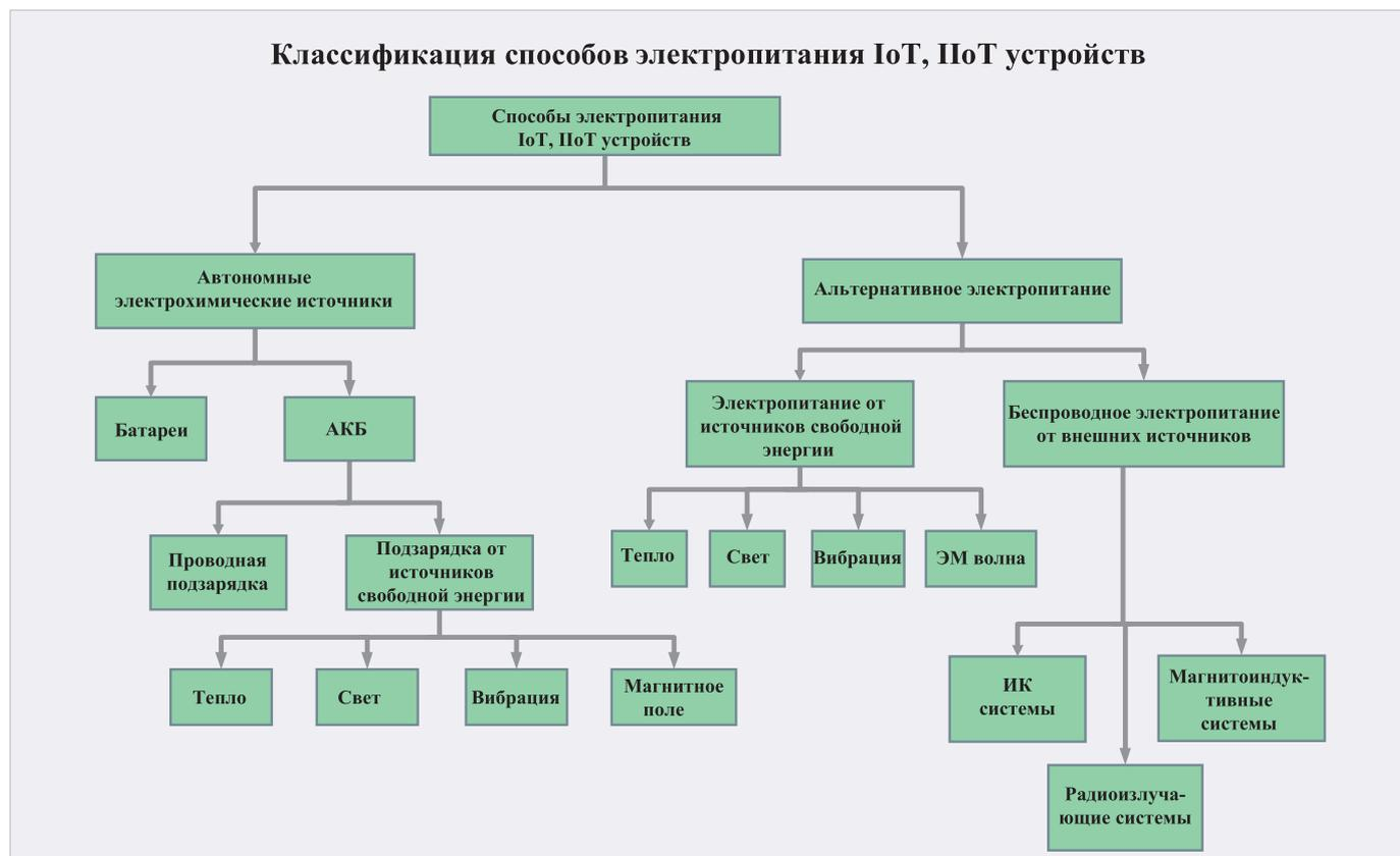
Рис. 1. Классификация способов электропитания IoT-устройств
