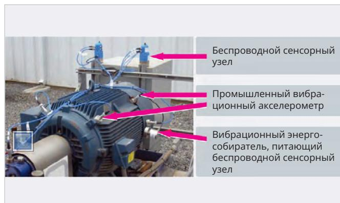
Рис. 5. Пример расположения сенсорных IoT-устройств
