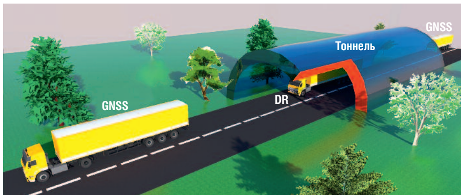
Рис. 5. Технология DR позволяет отслеживать транспорт в туннелях
