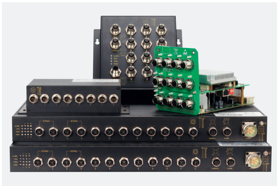
Рис. 8. Управляемые коммутаторы серии Admas, соответствующие стандарту EN50155
