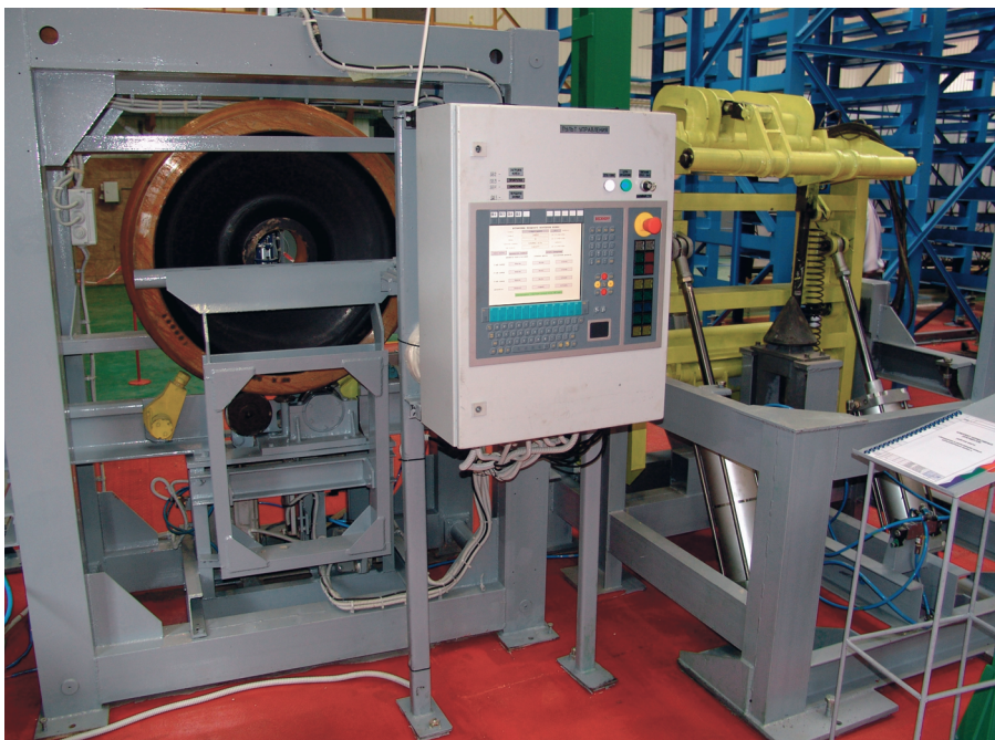
Рис. 3. Установка входного контроля параметров колёс
