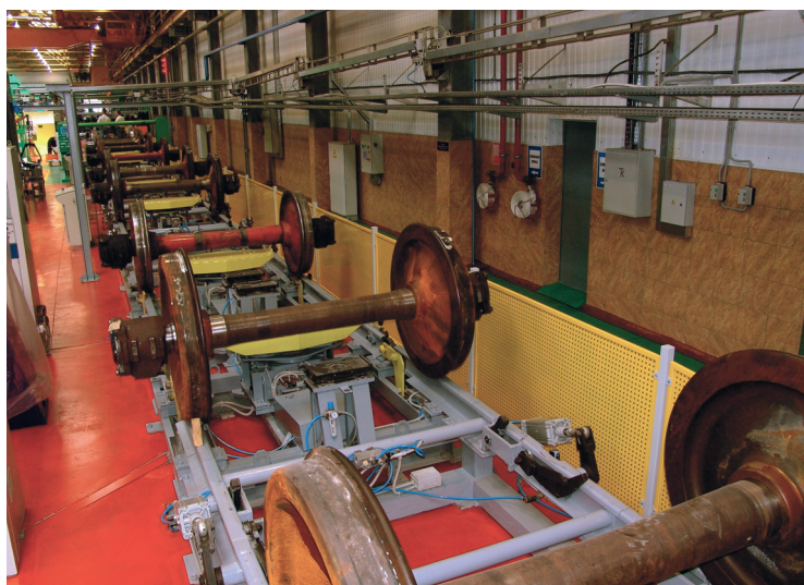
Рис. 8. Транспортёр перемещения колёсных пар
