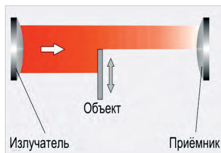
Рис. 1. Иллюстрация функционала бесконтактного оптоэлектронного датчика
