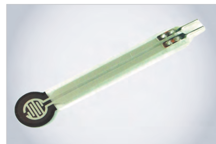
Рис. 6. Тензорезистор RFP602 для измерений в диапазоне 0...1 кг
