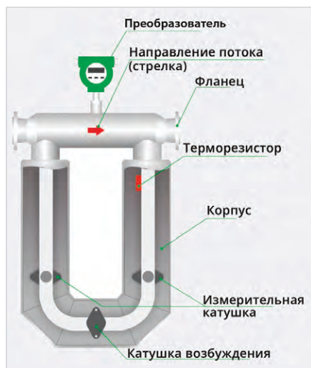
Рис. 11. Принцип работы кориолисового расходомера
