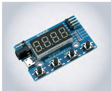
Рис. 18. Внешний вид модуль-контроллера весовых ячеек с индикатором
