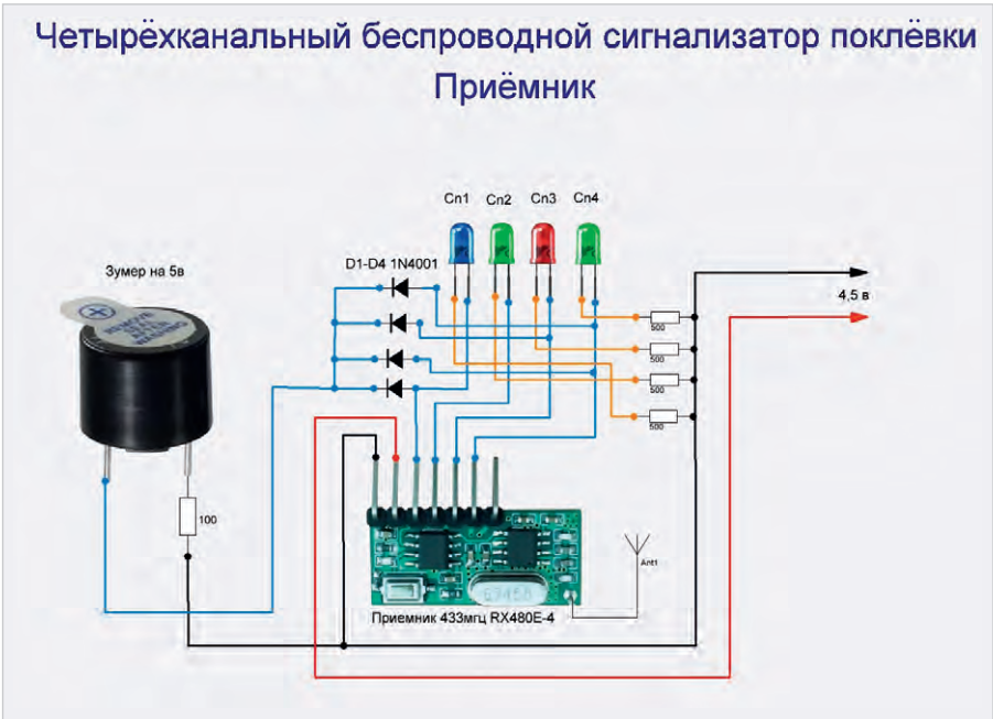
Рис. 10. Приёмник на модуле RX480E-4
