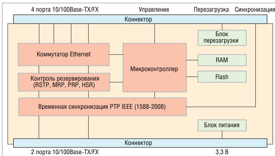
Рис. 4. Функциональная схема встраиваемого Ethernet-модуля Hirschmann EES20
