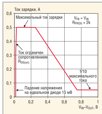
Рис. 2. В нормальном режиме профиль тока заряда суперконденсатора предотвращает броски тока
