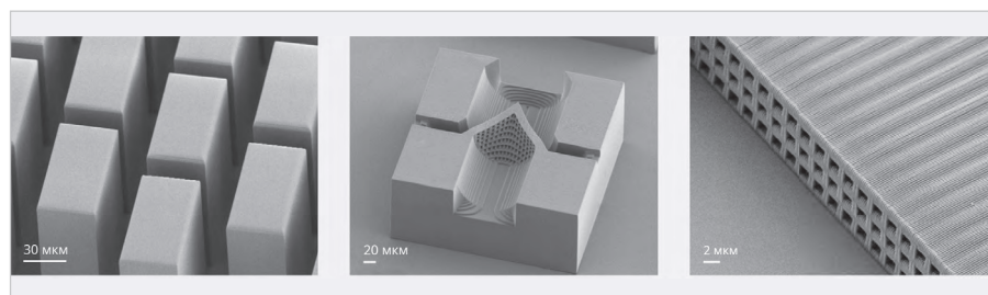
Рис. 20. Микроминиатюрные капиллярные системы, изготовленные методом 3D-печати
