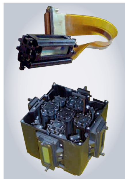
Рис. 96. Внешний вид макетного образца МП-В ВС с 16 функциональными 3D М ФЭФ М базового ряда с оптическими пространственными связями и оптическими мультиплексными элементами
