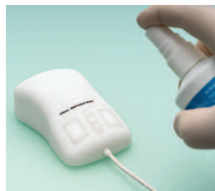
Рис. 8. Защищённая мышь серии InduMouse® Pro
