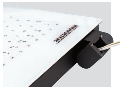
Рис. 7. Механизм складывания клавиатуры
