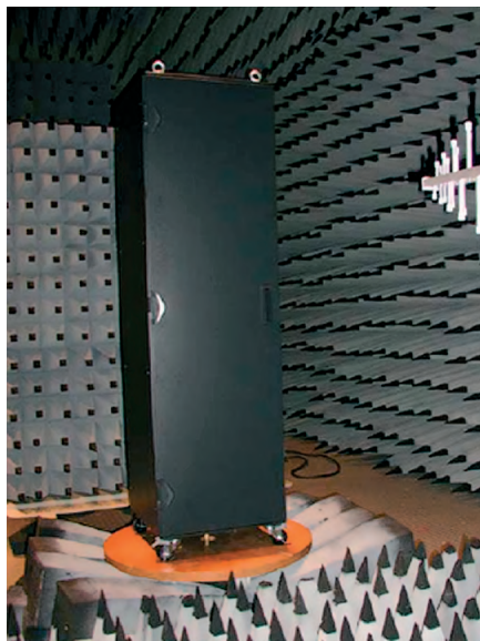
Рис. 8. Испытания шкафа VARISTAR в электромагнитной безэховой камере университета Карлсруэ
