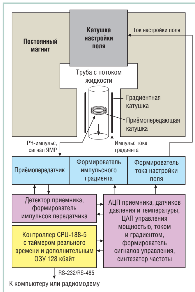
Рис. 2. Блок-схема измерителя расхода и состава скважинной жидкости
