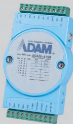
ADAM-4150 Модуль дискретного ввода-вывода
