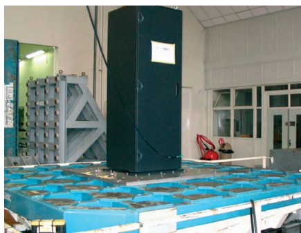
Рис. 5. Испытания шкафа на сейсмостойкость в лаборатории Soremea (Париж)
