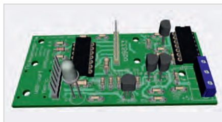
Рис. 7. 3D-модель печатной платы сканирующего адаптера 1wire
