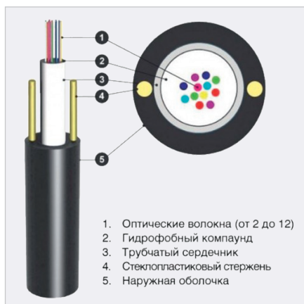
Рис. 4. Оптоволоконный кабель ADSS8-1
