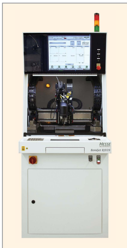
Рис. 3. Установка для разварки толстой проволокой Hesse Mechatronics VJ939
