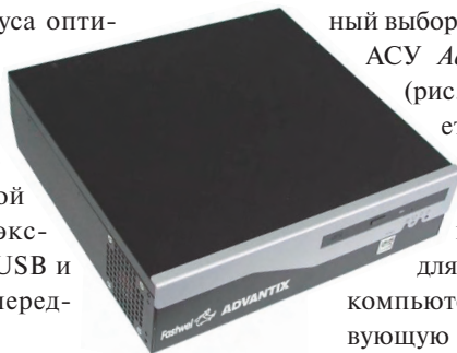
Рис. 2. Компактная станция оператора ACU AdvantiX ITX-D-SYS8
