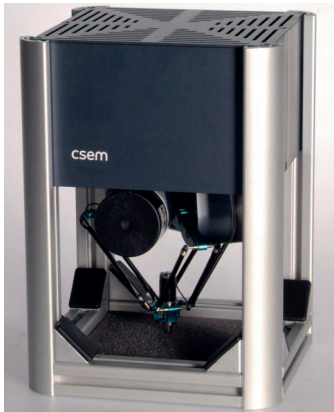
Рис. 5. Робот PocketDelta компании CSEM предназначен для сборки сложных миниатюрных устройств и построен на основе QNX
