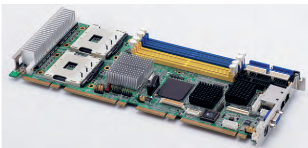
Рис. 5. Двухпроцессорная плата стандарта PICMG 1.3 Advantech PCE-7210
