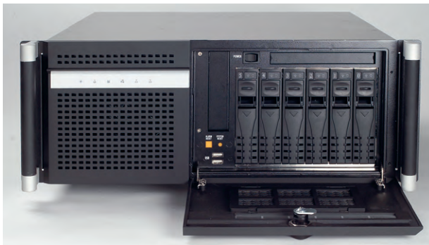
Рис. 7. 4U-корпус для промышленного сервера хранения Advantech ACP-4362
