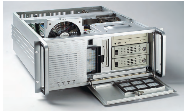
Рис. 6. 4U-корпус для промышленного ПК общего назначения Advantech IPC-630
