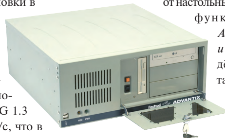
Рис. 1. Станции оператора АСУ IPC-SYS1-1/IPC-SYS1-2
