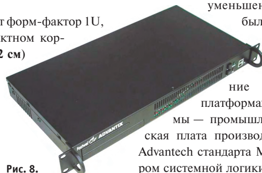
Рис. 8. Телекоммуникационный промышленный сервер 1U ITX-1U-SYS8
