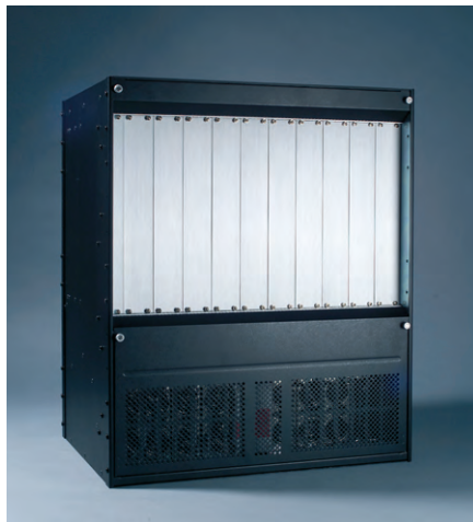
Рис. 3. Отказоустойчивый корпус MIC-3082A Advantech
