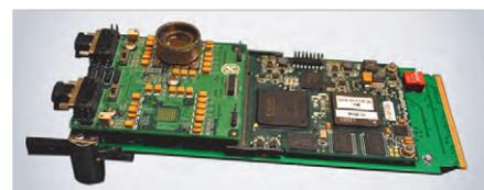
Рис. 29. Процессорная плата стандарта 3U с 16 электронными портами 64-разрядного интерфейса EMIF и управляющим процессором 1892ВМ14Я
