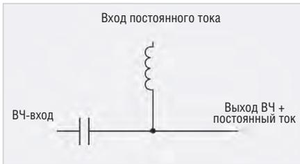
Рис. 6. Эквивалентная схема тройника смещения
