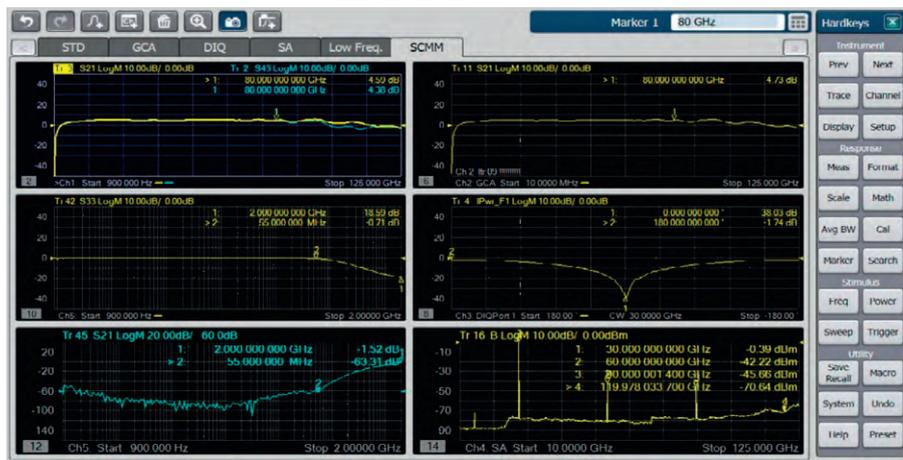
Рис. 4. Выполнение нескольких измерений векторным анализатором серии PNA-X за одно подключение
