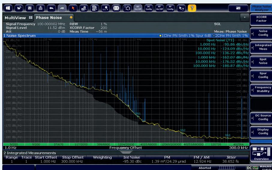
Рис. 2. Фазовые шумы ГК359-ТС
