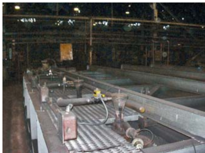
Рис. 2. Рампа обжиговой камеры с органами управления
