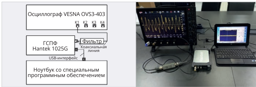
Рис. 6. Измерительная установки для случая соединения осциллографа и генератора через фильтр: а) схема; б) фотография
