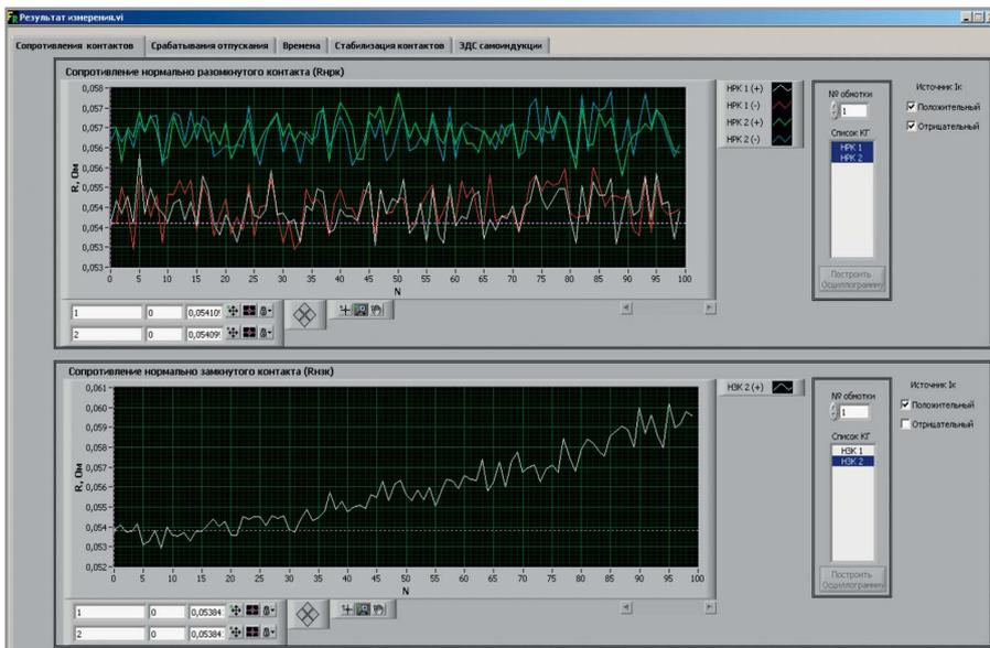
Рис. 7. Отображение на встроенном осциллографе процесса приработки контактов реле
