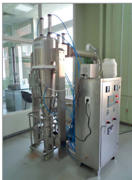
Рис. 2. Распылительное сушило для получения пресс-порошка нитрида алюминия
