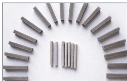
Рис. 1. Объёмные изделия из алюмонитридного гранулята
