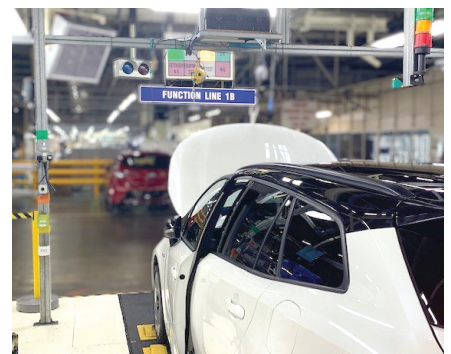
Рис. 4. Сигнальная лампа показывает, находится ли испытательная процедура в оптимальных временных рамках
