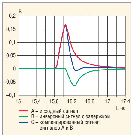
Рис. 3. Компенсация МСИ при использовании предискажения
