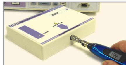
Рис. 5. Адаптер калибровки динамометрических ключей
