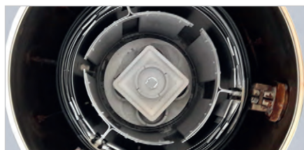
Рис. 6. Вакуумная камера установки Сатсо с установленным диском из нитрида алюминия с УНТ и пластинами кремния перед пропиткой
