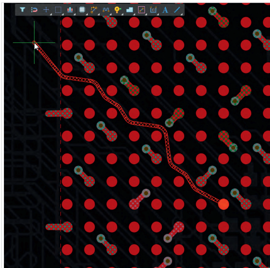
Рис. 1. Режим Snake Routing интерактивной трассировки
