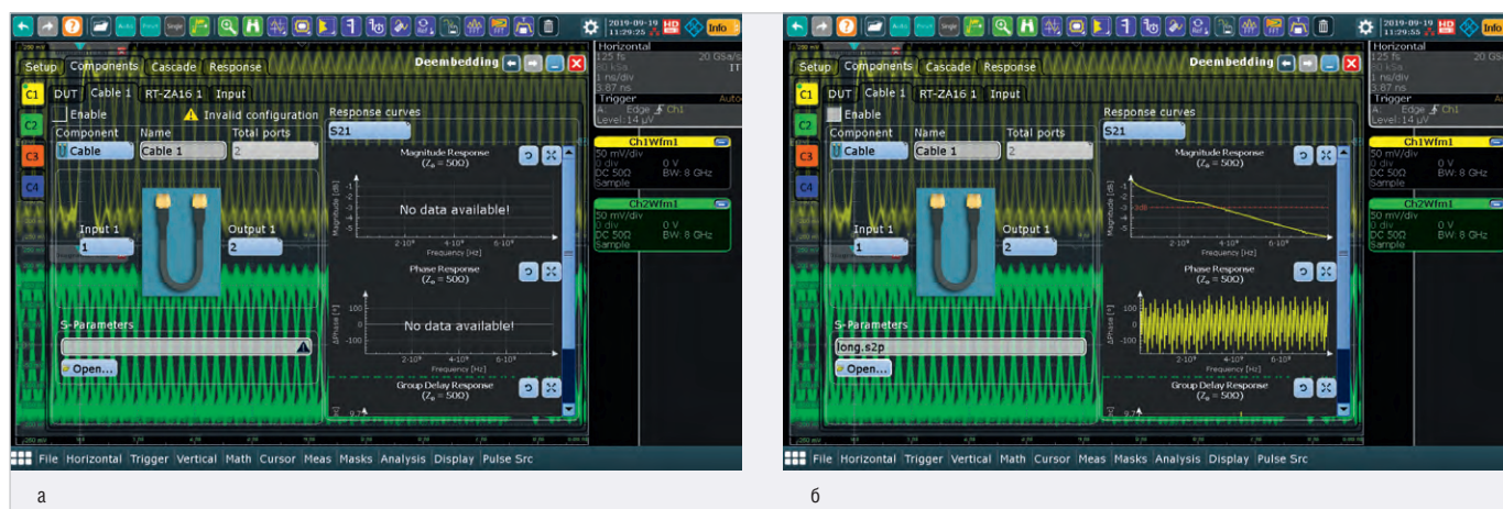
Рис. 7. Загрузка файла с S-параметрами для кабеля в составе измерительной установки: а) первоначальное окно; б) окно после загрузки файла с S-параметрами
