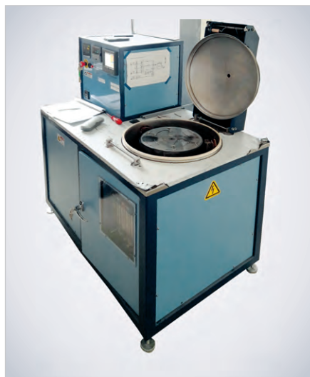
Рис. 4. Установка Сатсо для пропитки УНТ кремнием
