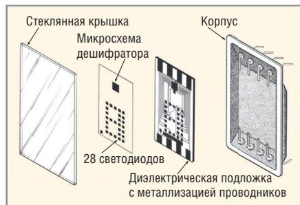
Рис. 1. Устройство светодиодного индикатора
