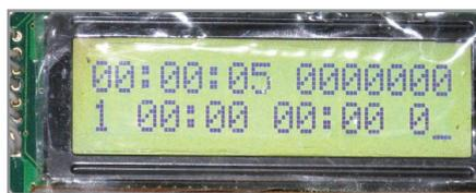
Рис. 7. ЖК-индикатор таймера № 1 в режиме «интервал 1»
