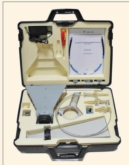
ства (в том числе диэлектрические), обеспечивающие наведение антенн в трёх плоскостях и установку заданной высоты, а также субгармонические смесители, обеспечивающие измерение в диапазоне рабочих частот 26,0...110,0 ГГц при отсутствии анализаторов спектра данного диапазона.
