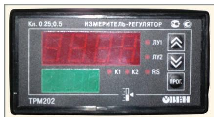
Рис. 4. Лицевая панель терморегулятора TRM202
