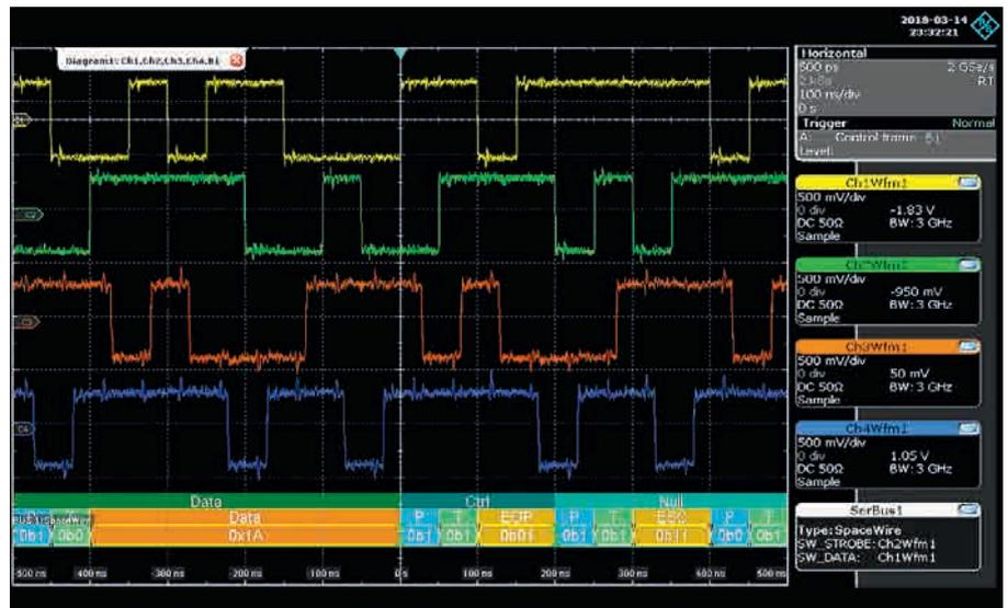
Рис. 2. Графическое представление декодированных данных с запуском по символу EOP
