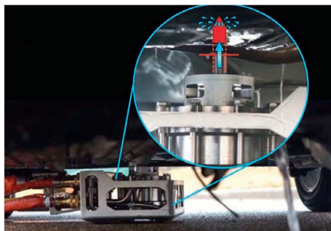
Рис. 5. Принцип подачи воды на тушение батареи
