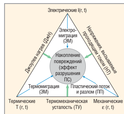
Рис. 2. Процесс накопления повреждений в результате воздействия различных полей нагрузок, возникающих во время эксплуатации (прямые процессы – ЭМ, ПП, ТМ), и их взаимодействия друг с другом (процессы, действующие совместно – ТМУ, ДжН, НТ)
