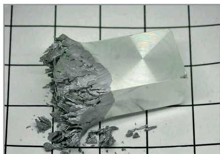
Рис. 8. Левая часть оловянного бруска перешла в \alpha -фазу, правая остаётся в \beta -фазе
